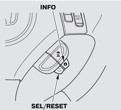
С помощью кнопок SEL/RESET или INFO вы можете изменить вид дисплея и выбрать управляющие настройки автомобиля.
