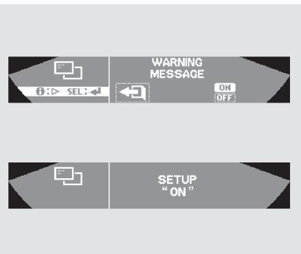
Если функция WARNING MESSAGE (Предупреждающее сообщение) активирована (ON), то при возникновении неисправности автомобиля на экране дисплея появятся соответствующее информационное сообщение и предупреждающий символ. Выберите ON (вкл.) или OFF (выкл.) с помощью кнопки INFO и нажмите кнопку SEL/RESET для подтверждения выбора. На экране дисплея появится подтверждающее сообщение (на две секунды). После этого будет снова загружено окно «CUSTOMIZE ENTRY».
