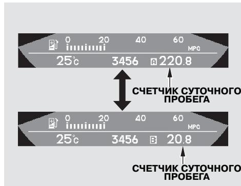
Этот счетчик показывает пробег автомобиля (в милях или километрах) с момента последнего обнуления его показаний. Предусмотрено два счетчика суточного пробега: Счетчик А и счетчик В. Они работают независимо друг от друга, так что вы можете одновременно отслеживать два отдельных маршрута.
