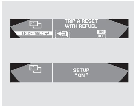
Вы можете включить или выключить режим, при котором показания счетчика суточного пробега A и соответствующее им значение среднего расхода топлива будут автоматически обнулены при дозаправке автомобиля. Выберите ON (вкл.) или OFF (выкл.) с помощью кнопки INFO и нажмите кнопку SEL/RESET для подтверждения выбора. На экране дисплея появится подтверждающее сообщение (на две секунды).
