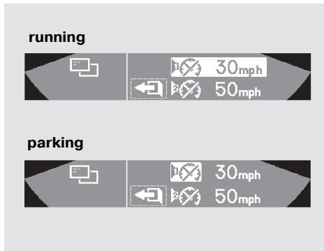
Вы можете включить или выключить данную функцию. Всего предусмотрено два значения скорости, при которой включается предупреждающий сигнал (скорость 1 и скорость 2). Выберите скорость 1 или 2 с помощью кнопки INFO и нажмите кнопку SEL/RESET для подтверждения выбора. На экране дисплея появится подтверждающее сообщение (на две секунды).
