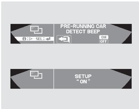
Если функция PRE-RUNNING CAR DETECT BEEP включена (ON), то при появлении перед вашим автомобилем другого транспортного средства раздается звуковой сигнал. Сигнал будет звучать даже после того, как впереди идущий автомобиль покинет радиус действия радара системы круиз-контроля.
