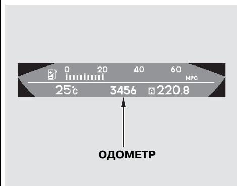
Одометр показывает общий пробег вашего автомобиля в милях или километрах.
